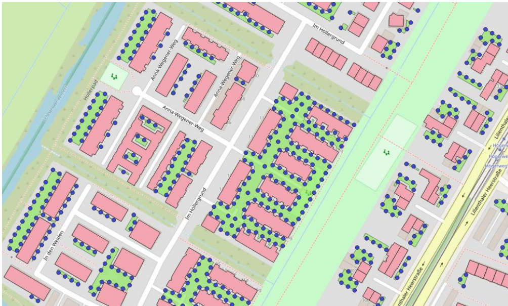
Abbildung 70: Darstellung der Platzierung der EWS auf den Grundstücken für ein Beispielgebiet: Platzierungsbereich auf den Grundstücken (hellgrün); Mögliche Sondenstandorte (blaue Punkte)
