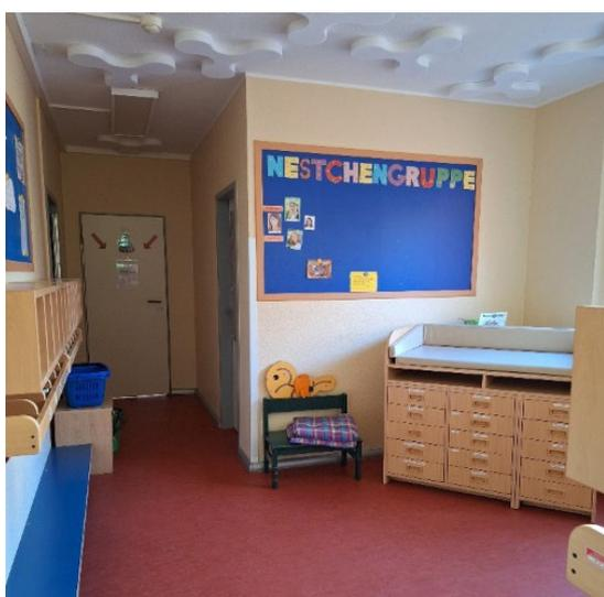
Garderobe mit neuen Deckenleuchten, Schallschutzplatten und Linoleumbelag
