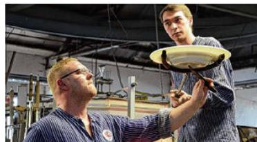
Fast fertig: Bevor der Teller zum Aushärten in den Tempa-Ofen gelegt wird, überprüfen die Glasmacher die Rundung.
