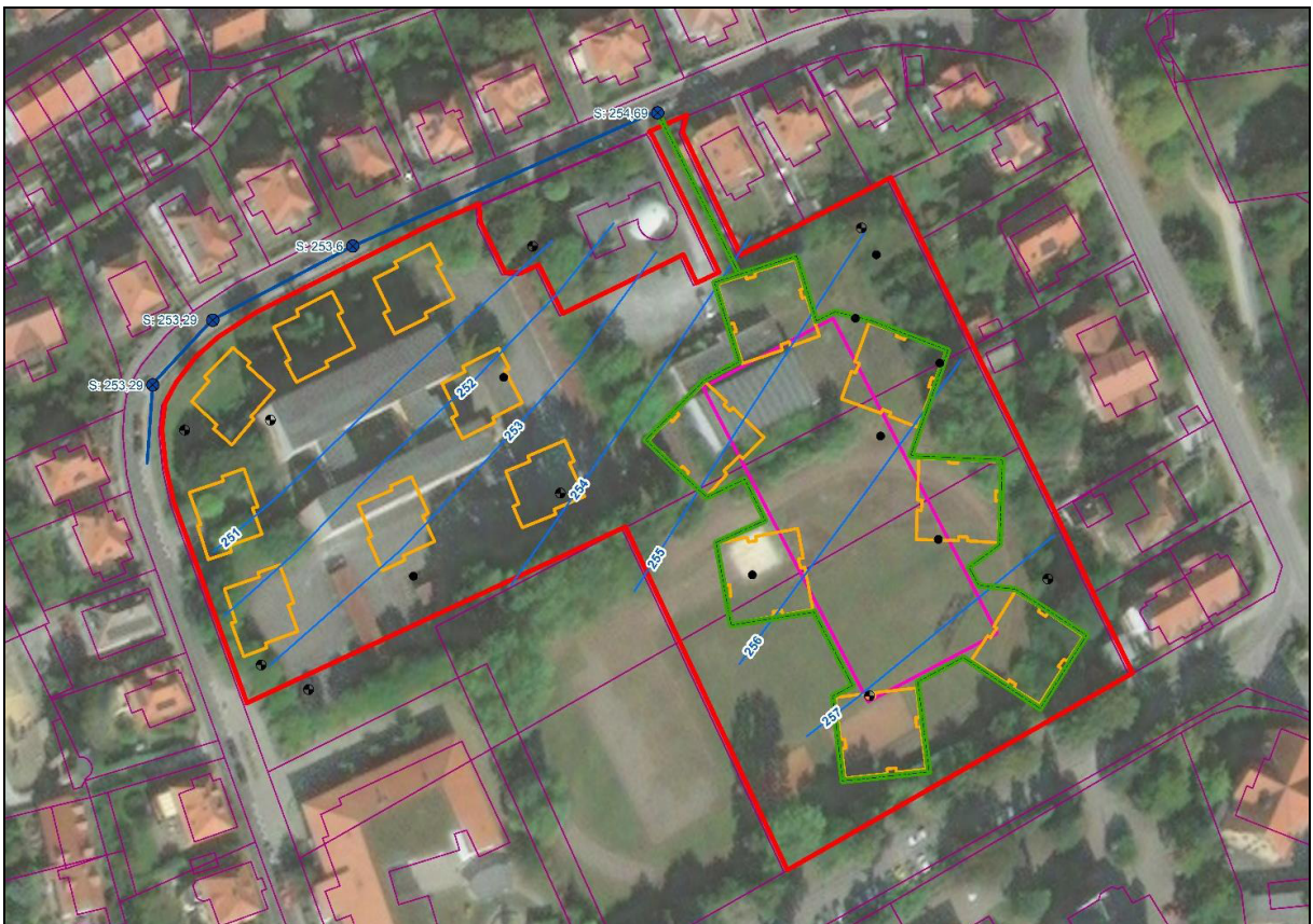
Abbildung 12: Übersicht der vorgeschlagenen Ringdränagen
