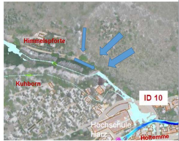
Abbildung 13: Einzugsgebiet 72B Himmelpforte (links) mit besonderem Problem des Hangwassers (blaue Pfeile rechts).
